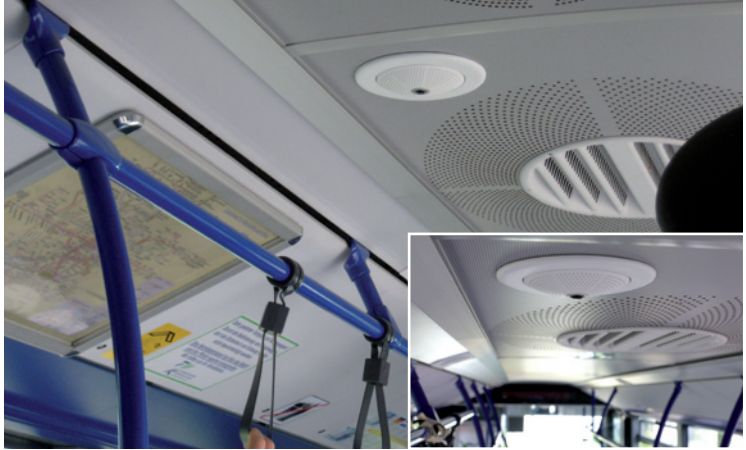
Q24M im Deckeneinbau-Set (Nahverkehrsbus)
